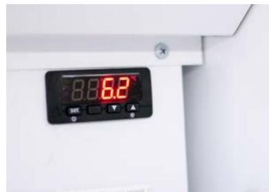
Для управления холодильной системой используется электронный контроллер, который находится в зоне легкого доступа, а яркая индикация на лицевой панели, позволяет в любой момент с высокой точностью определить фактическую температуру внутри шкафа. Всего за несколько секунд, можно произвести коррекцию работы оборудования с учетом температуры окружающей среды и частоты открывания дверей.
